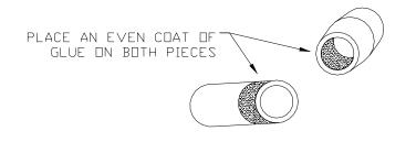
INSERT PIPE STRAIGHT INTO FITTING AND TWIST SLIGHTLY
